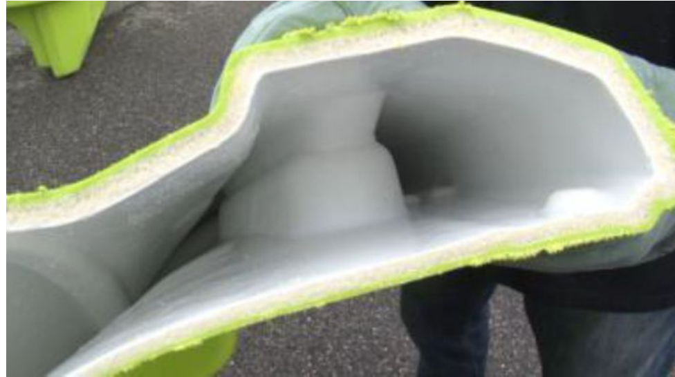
将来のリサイクルを視野にPE系材料で統一（日本はCF）
