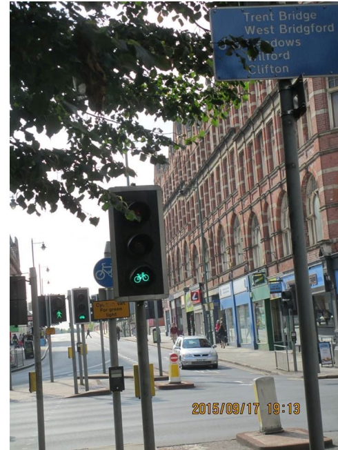
ノッティンガムの自転車レーンの表示と自転車専用信号
